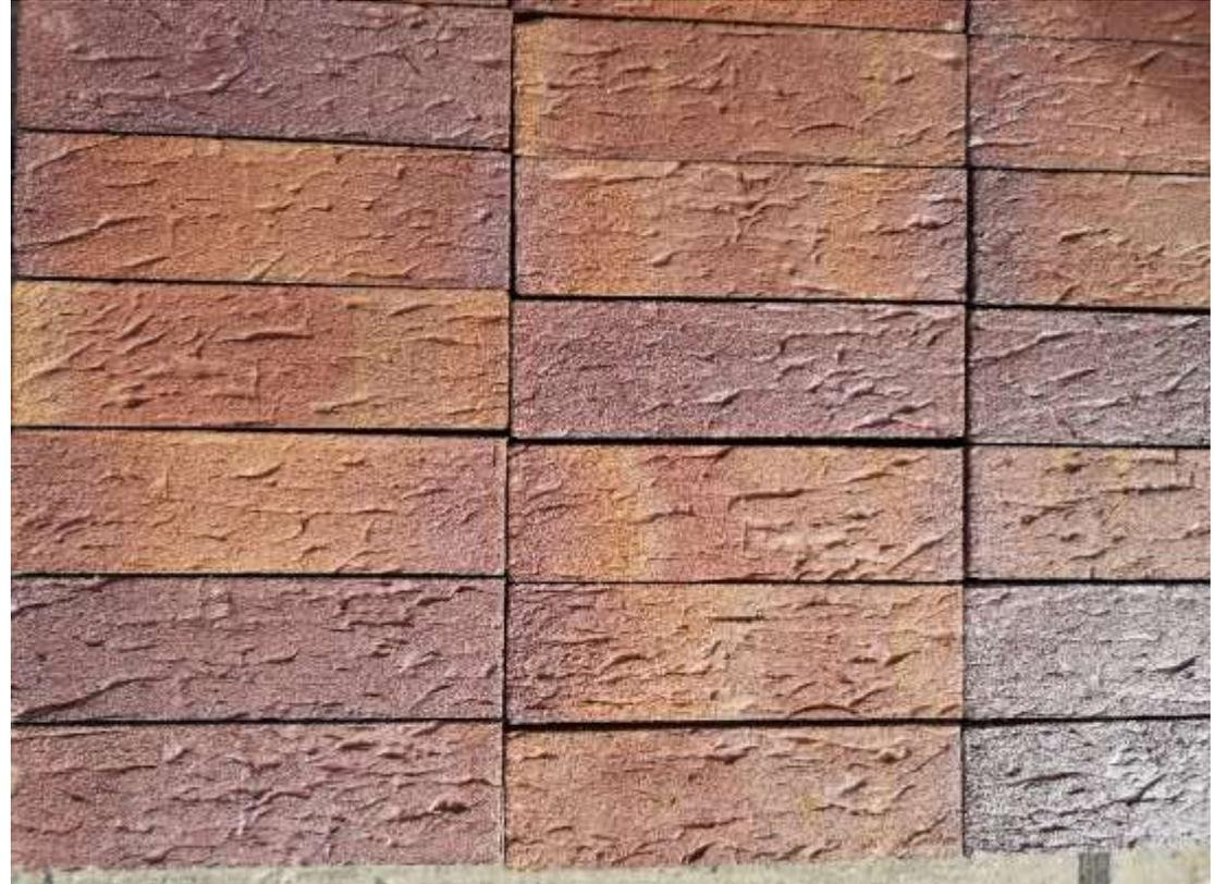
Офактуривание, это искусственное механическое воздействие на поверхность кирпича, благодаря которому поверхность приобретает оригинальную структуру.
