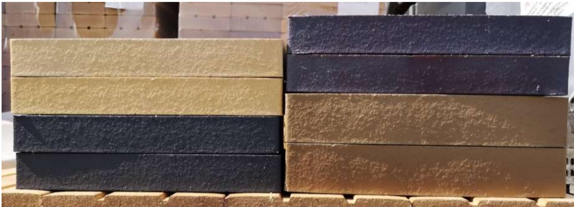
Применение на фасаде ригельных кирпичей размеров 290\*40\*90мм. или 290\*52\*90мм., даже без их дополнительной обработки, способно значительно повлиять на восприятие фасада. Узкий по высоте и в то же время удлинённый клинкерный кирпич особенно выразительно смотрится на домах с более продолговатыми фасадами и особенно с плоской кровлей.
